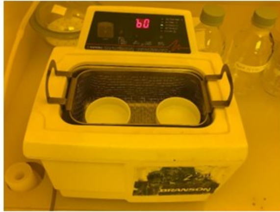
Figura 36: Macchina a ultrasuoni utilizzata nella cleanroom.
