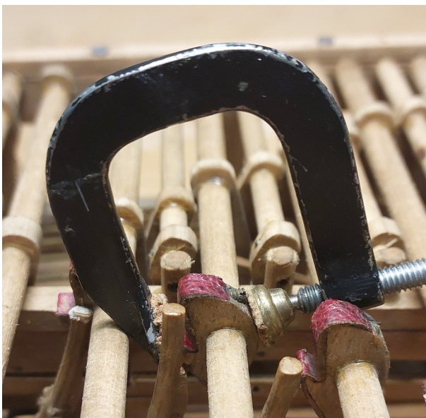
Figura 36: Consolidamento del nasetto della noce del tasto numero 2.
