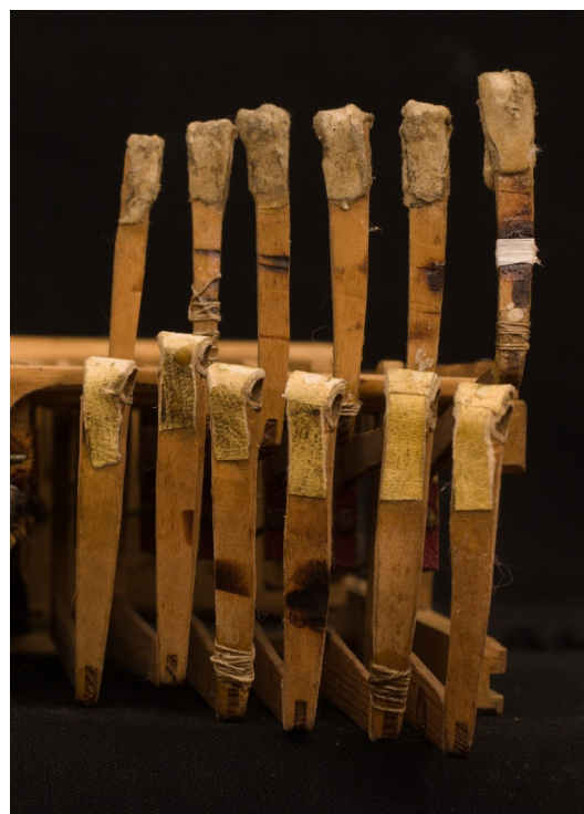
Figura 23: Martelletti e smorzatori con segni di combustione.
