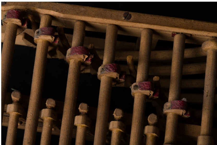
Schaubild 20: Un dettaglio della meccanica pianoforte che mostra le noci dello scappamento e il fissaggio degli alberini.
