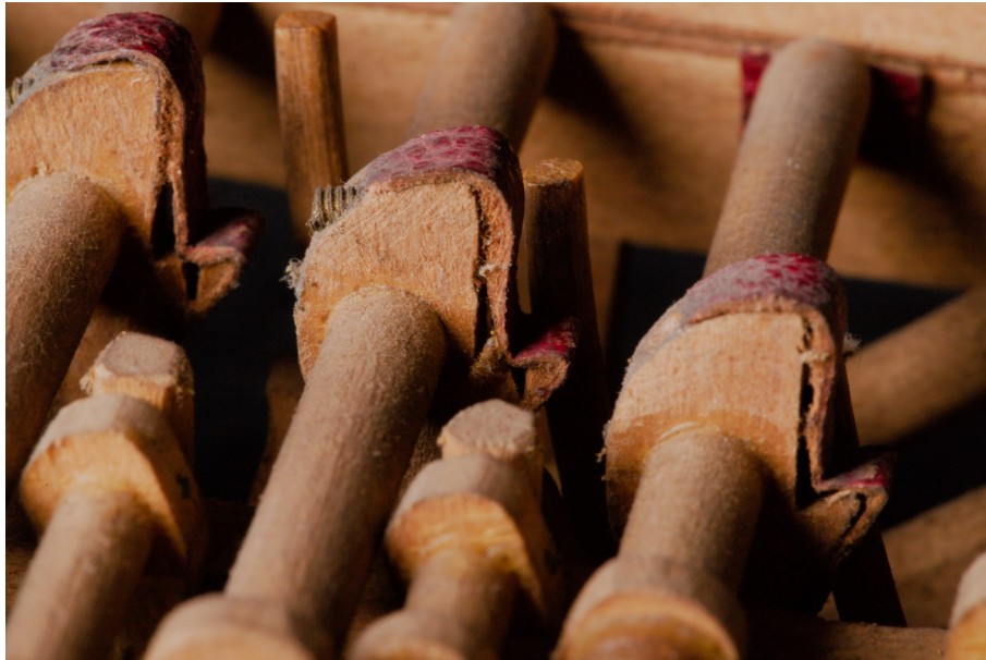
Figura 25: Frattura dei nasetti delle noci dello scappamento.
