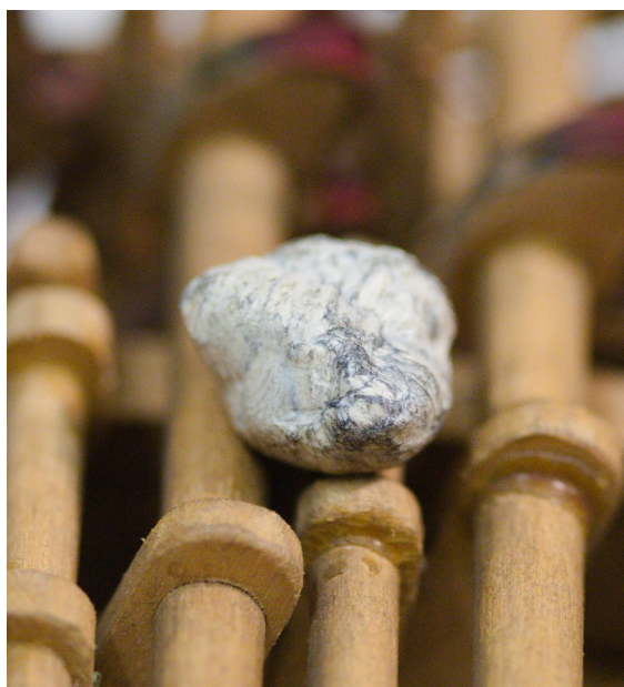
57 Figura 31: Pulitura a secco della meccanica pianoforte con gomma Groom Stick.
