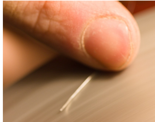
Figura 35: Sagomatura della molla nuova per lo scappamento del tasto numero 6.
