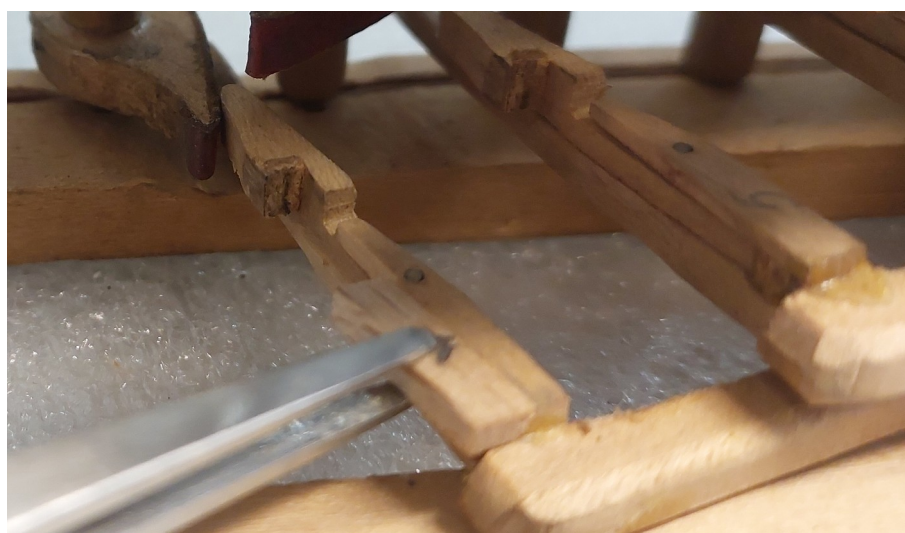
Figura 34: Integrazione del sostegno dello scappamento del tasto numero 6.
