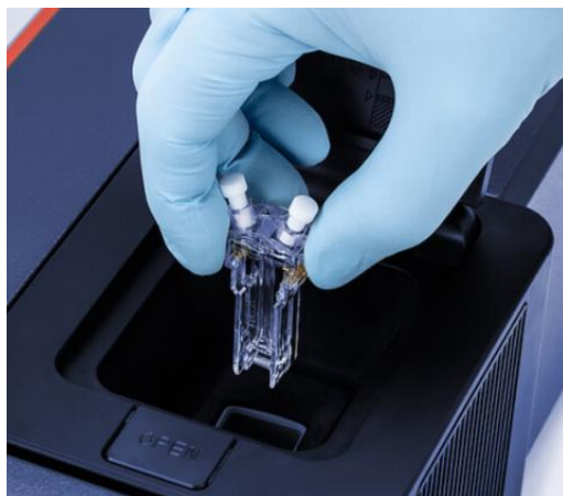
Figura 42. Cuvetta Omega utilizzata per determinare il Potenziale Zeta tramite strumento DLS.
